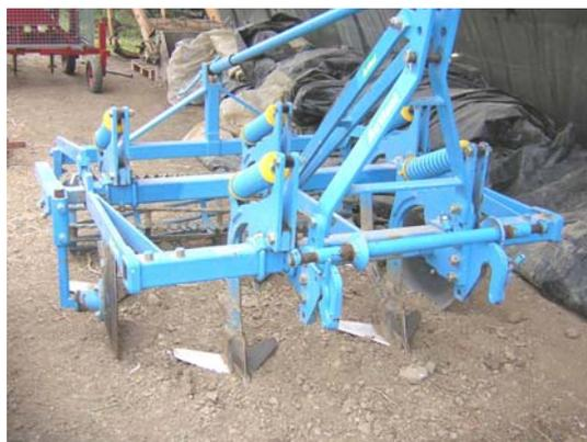
L'outil de base pour le travail en planche permanente est l'actisol équipé de disques concaves pour la formation des planches et de différentes dents selon les interventions à effectuer (travail superficiel, ameublissement, buttage) : ici, sur la photo actisol équipé de dents à ailette pour du travail superficiel. Pour des cultures qui demandent des lits de semences relativement fins, on pourra faire appel à des outils rotatifs à l'exemple du cultirateur.
