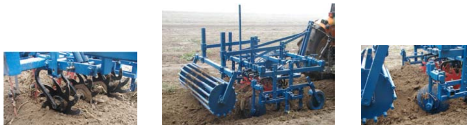
Les disques étoilés travaillent le sol, ils sont situés au centre de l'outil, les disques forment la butte
