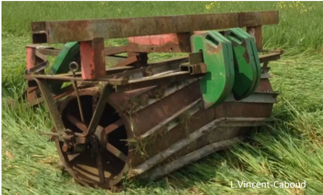
Rouleau cranteur construit en Rhône-Alpes dans le cadre d'essais en SDSC (ISARA-Lyon)
