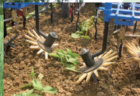
Bineuse à doigts : outil de désherbage mécanique
