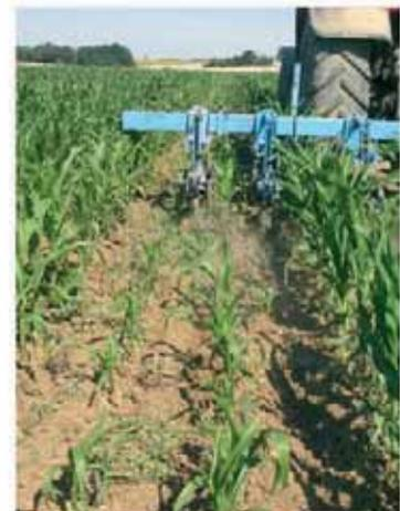
**Il est possible de biner avec un autoguidage RTK hydraulique**
