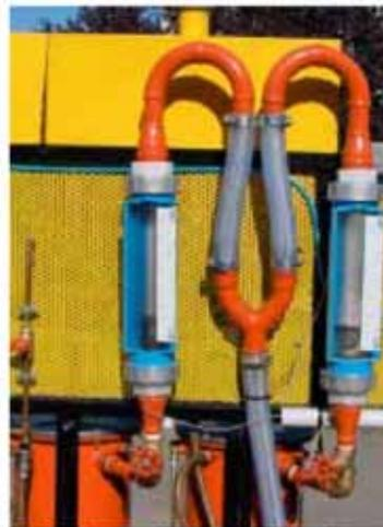
Fig 9 : Photographie détail des débitmètres gazeux et sortie des vapeur des évaporateurs.
