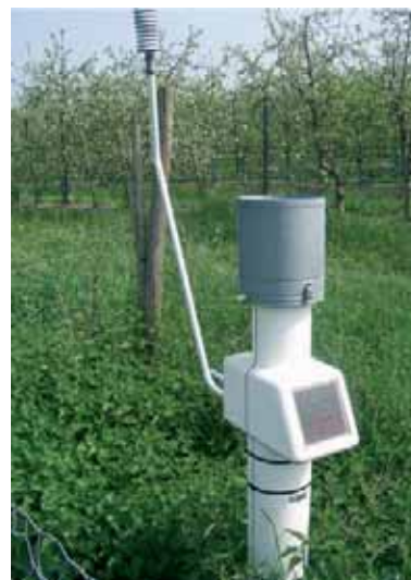
Sur chaque site, une station météo aide aux décisions. Les relevés sont transmis à un logiciel de prévisions de maladies.
