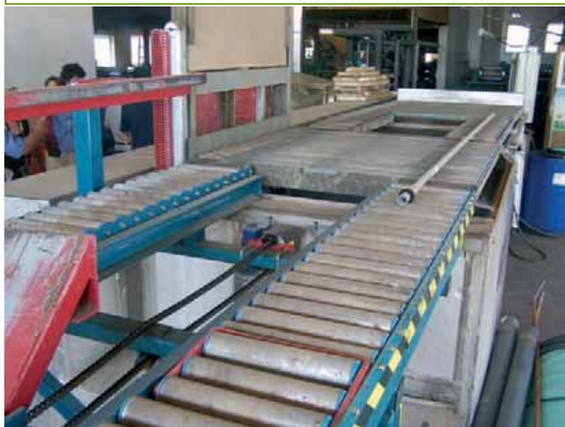
La machine traite 40 tonnes de pommes en huit heures et mobilise une personne.
