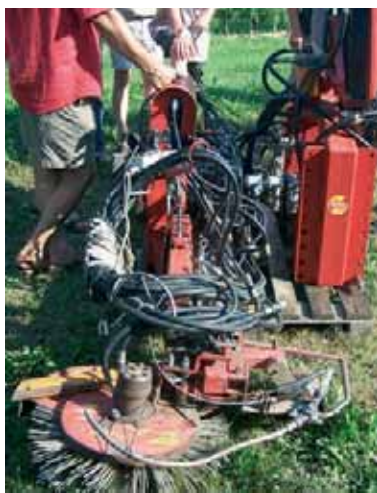
Le « rodéonator » de M. Blank est un appareil d'extermination des campagnols très peu « bio » : du propane et de l'oxygène sont injectés dans les galeries avant d'en provoquer l'explosion par une étincelle.
