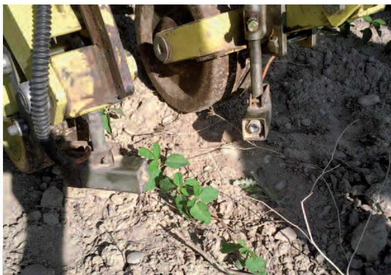
Interface de guidage électronique, placée entre le tracteur et la bineuse, destinée à améliorer le débit de chantier et la précision du binage.
