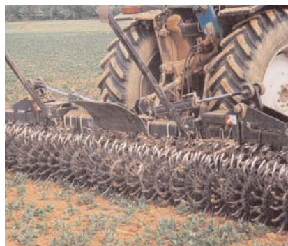
Photos 3 et 4 : Houe rotative YETTER (largeur 6m, 64 disques dentés, 21 dents par disque).
