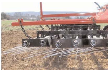
Photos 2 : Herse étrille QUIVOGNE (largeur 6 m, 6 possibilités d'inclinaison des dents, diamètre des dents de 7 mm).
