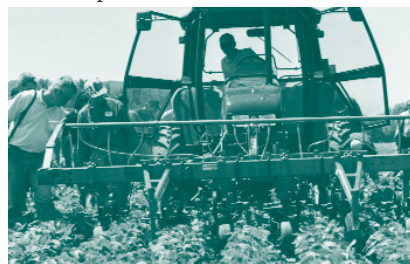
Dispositif de binage inter-rang et de désherbage thermique monté à l'avant du tracteur O. Durant
