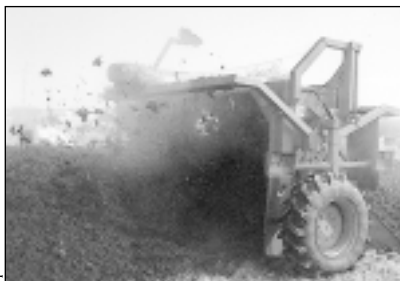
Épandeur avec roues motrices : ne nécessite pas de tracteur avec vitesse rampante, investissement de l'ordre de 200 KF
