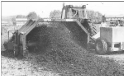
Épandeur tracté : nécessite un tracteur avec vitesse rampante, investissement de l'ordre de 100 KF
