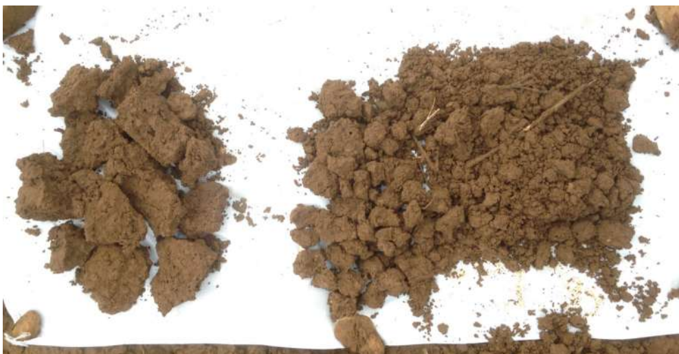
Figure 14: Répartition des horizons sur la bâche et classement des mottes: ici deux horizons sont séparés et caractérisés séparément
